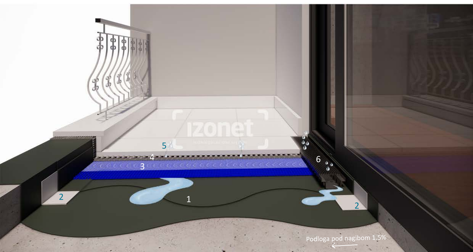
1. ARDEX 8+9 hidroizolacija 2. ARDEX SK 12 traka 3. WATEC DRAIN KP+ drenažni sloj 4. ARDEX FB 9 L ljepilo za kamen/keramiku 5. keramičko/kameno završno popločanje 6. AQUA DRAIN FLEX linijski slivnik
